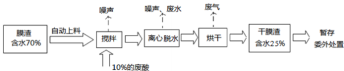
图 3.2-32 膜渣干燥工艺流程
